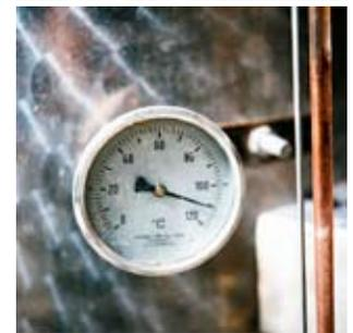
**TEMPERATUR** Die Brennkessel werden gleichmäßig und temperaturkontrolliert im Wasserbad erhitzt. Die Temperatur im Helm gibt dem Brenner Auskunft über die Art des aufsteigenden Alkohols.
