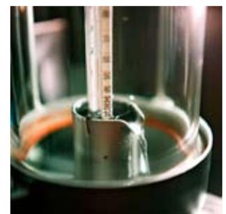
**ALKOHOL** Der Alkoholgehalt des aktuell aus dem Geistrohr fließenden Destillats kann an der sogenannten Spindel abgelesen werden.
