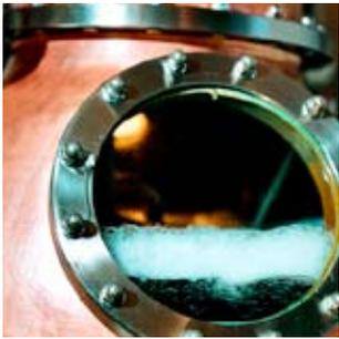
**FEINBRAND** Die Reinigung des Raubbrands von allen unerwünschten Sorten Alkohol erfolgt in einem zweiten Destillationsvorgang.
